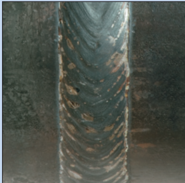
Acero carbono con MIG pulsada
